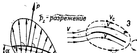
Рис. 56: Давления на парусе: 1 — распределение скоростей и давлений; 2 — результирующая сила; 3 — циркуляционное движение воздуха
